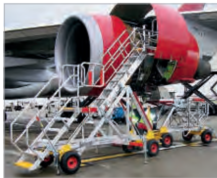
Plate-forme de maintenance à hauteur fixe, adaptée exactement au type d'avion
