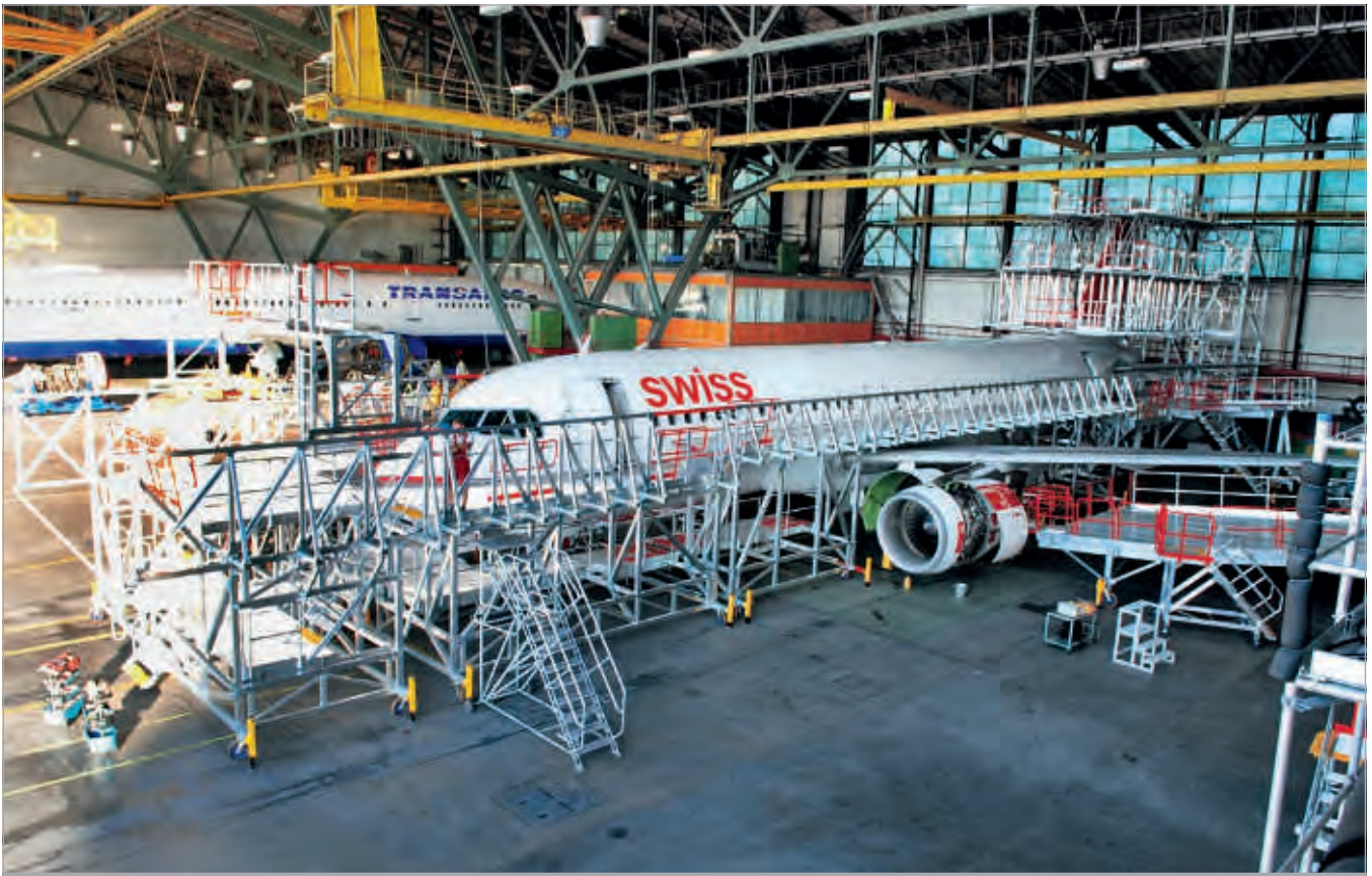
Installation de dock pour Airbus A320
