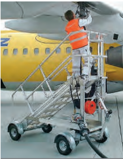
Plateforme de ravitaillement à hauteur fixe (voir p. 323)
