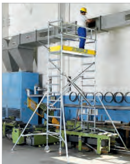
Les échafaudages mobiles sans traverse existent en deux largeurs (0,75 m et 1,35 m) ils peuvent être montés jusqu'à 10,40 m. La hauteur sans traverse peut atteindre 1,90 m (au milieu).
