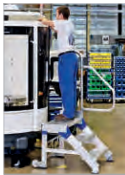
Podium à marches pour les travaux de montage sur les machines et installations
