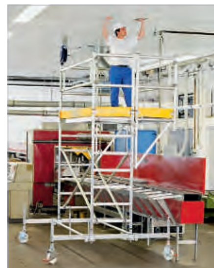
Des consoles de trois longueurs (1,80 m, 2,50 m et 3,00 m) peuvent être montées sur les échafaudages mobiles avec embase roulante jusqu'à une hauteur de travail de 8,60 m.
