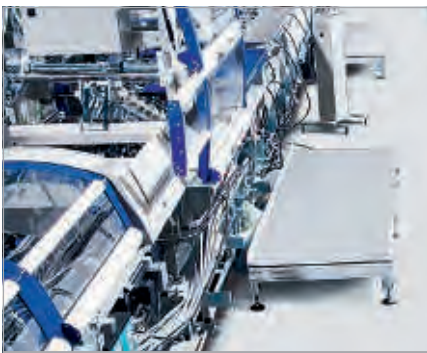
Plate-forme de travail avec pieds de machine réglables pour commande de l'installation
