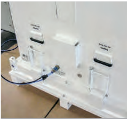
Conteneur étanche à la vapeur d'eau lors contrôle d'étanchéité par surpression
