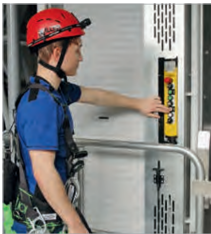
Porte à volet roulant avec panneau de commande amovible
