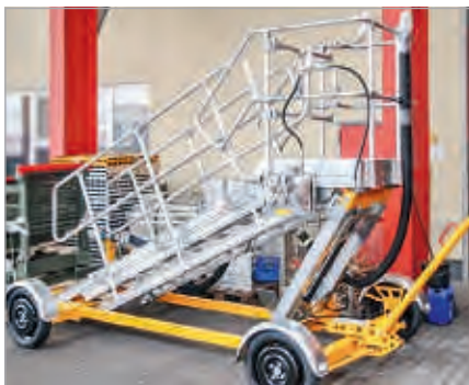
Plate-forme de ravitaillement avec réglage en hauteur hydraulique
