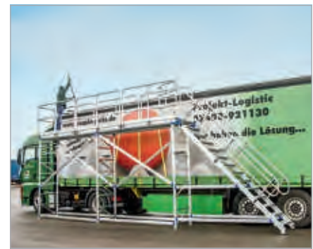
Echafaudage de travail pour le dégivrage de camion
