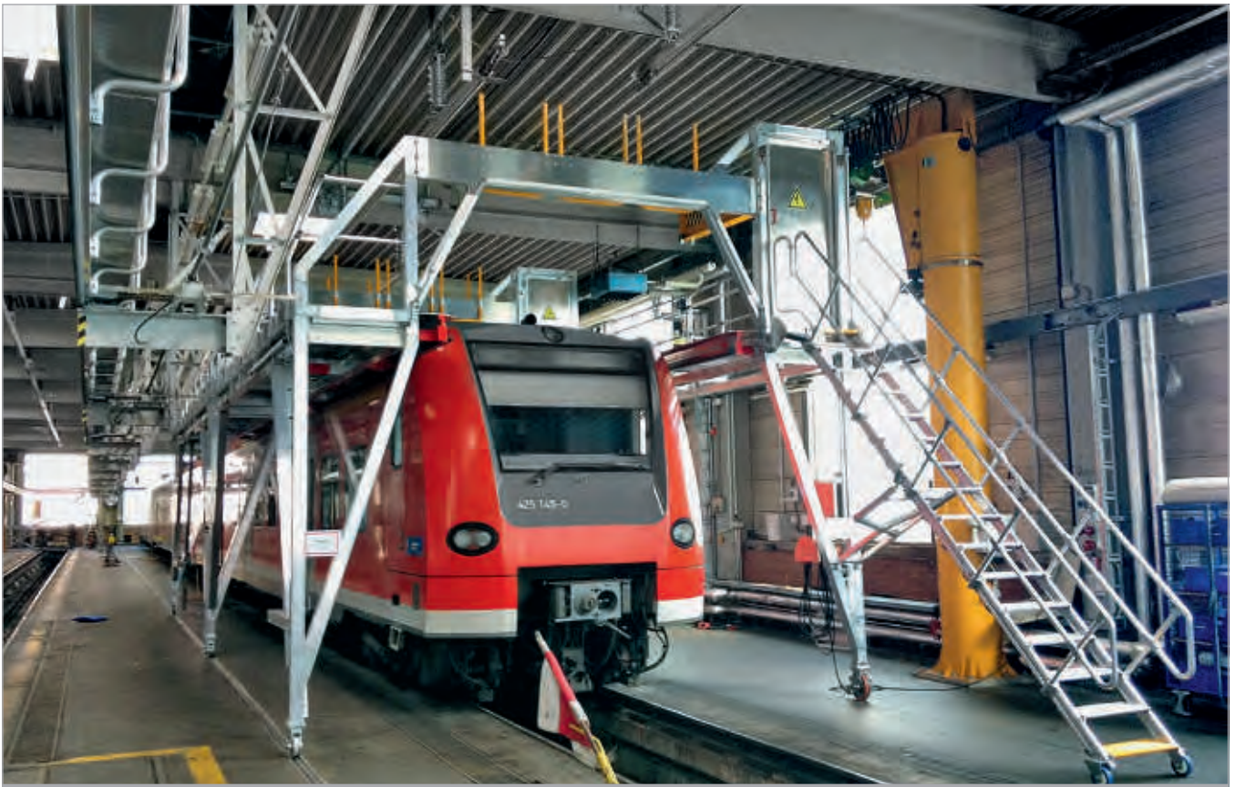
Plate-forme de travail en portique pour interventions sur le toit, guidée sur rails
