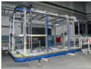
Démontage de la cabine
