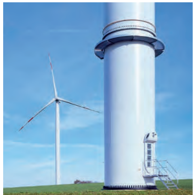
Escalier extérieur pour éolienne (voir p. 326)
