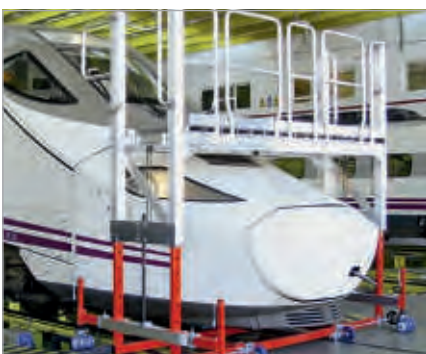
Plate-forme de travail avant réglable en hauteur avec train de roulement sur rails
